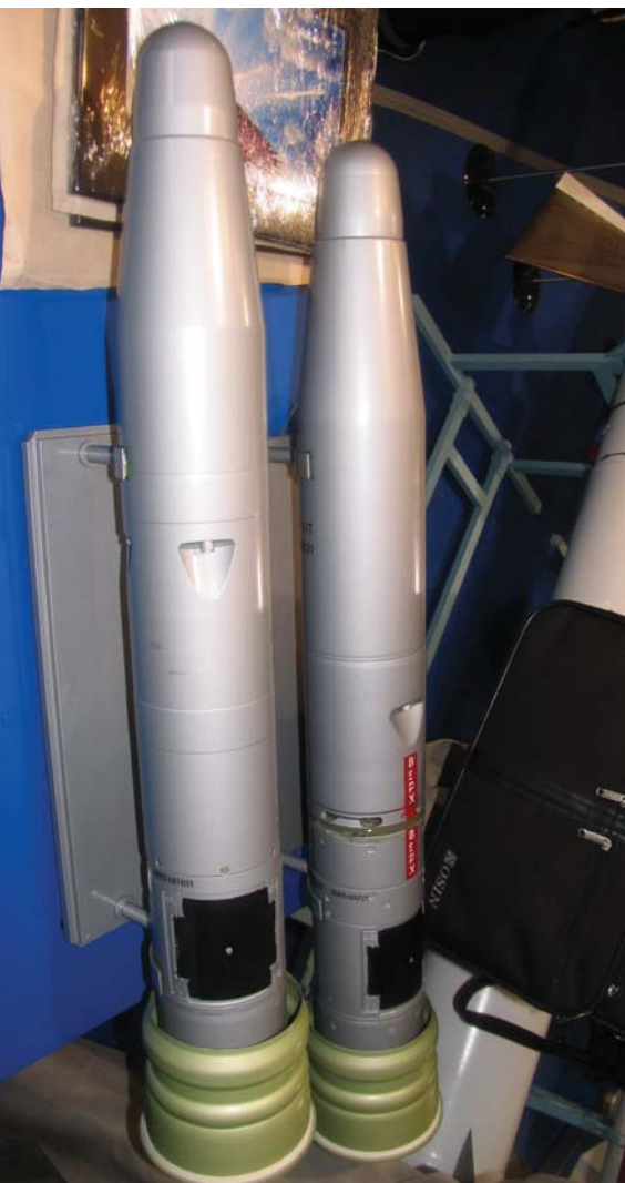
Противоклојна вођена ракета „комбат“, калибра 125 mm (лево), и „конус“ 120 mm за шойове по НАТО стандарду (десно)
