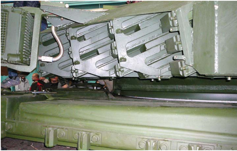
Пресек ЕРО „дүйлеш” са четири модула „нож” на куполи тенка „ојлош-М”
